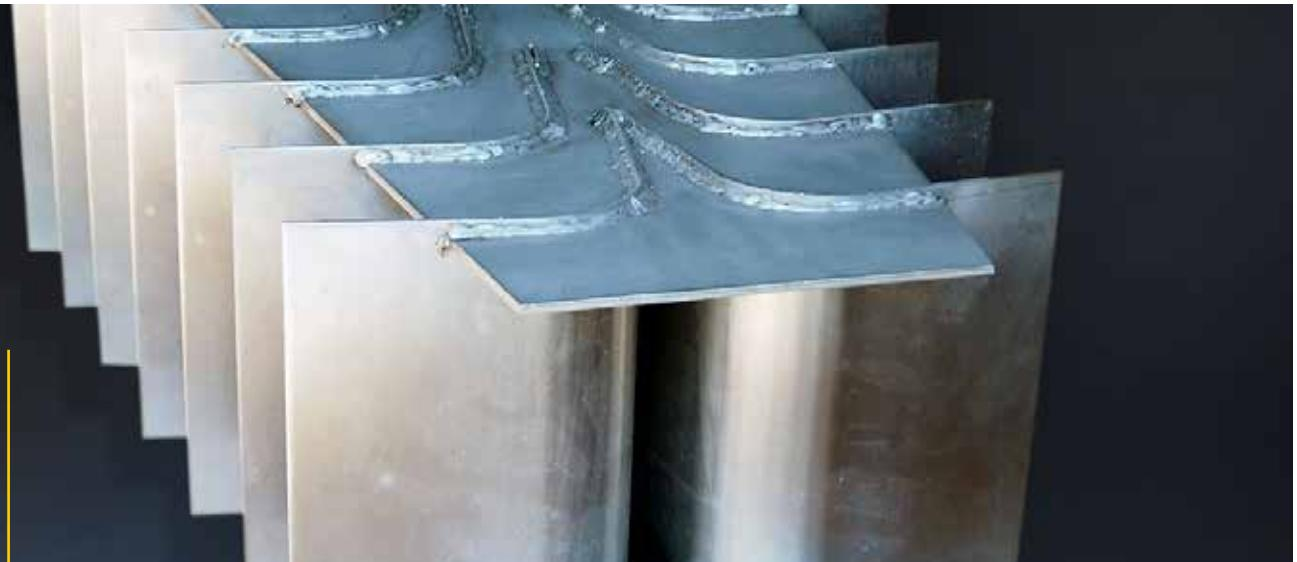
Se construyen a partir de placas curvadas ubicadas de manera tal que dividen gradualmente el flujo ingresante. Así reduce su velocidad drásticamente y cambian el momento. Favorecen una rápida separación de gases. Reducen la agitación y el splash provocado por ingresos de slug y minimizan el rearrastre de gotas en el gas.
