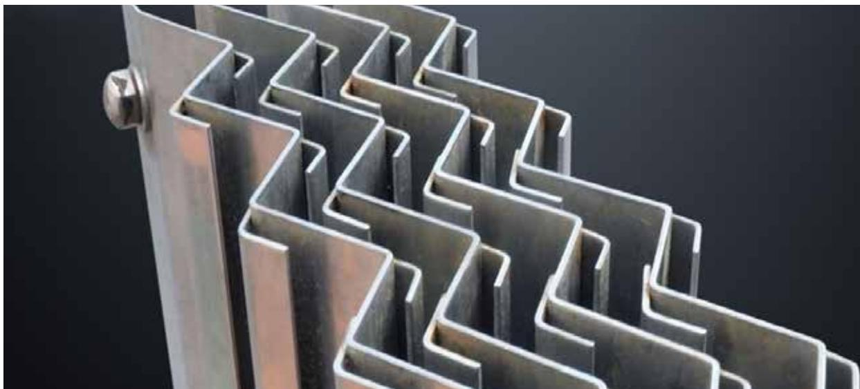
Las Chicanas (Vanes) favorecen la coalescencia y retención de las gotas de líquido arrastradas por el gas en fases gaseosas.
